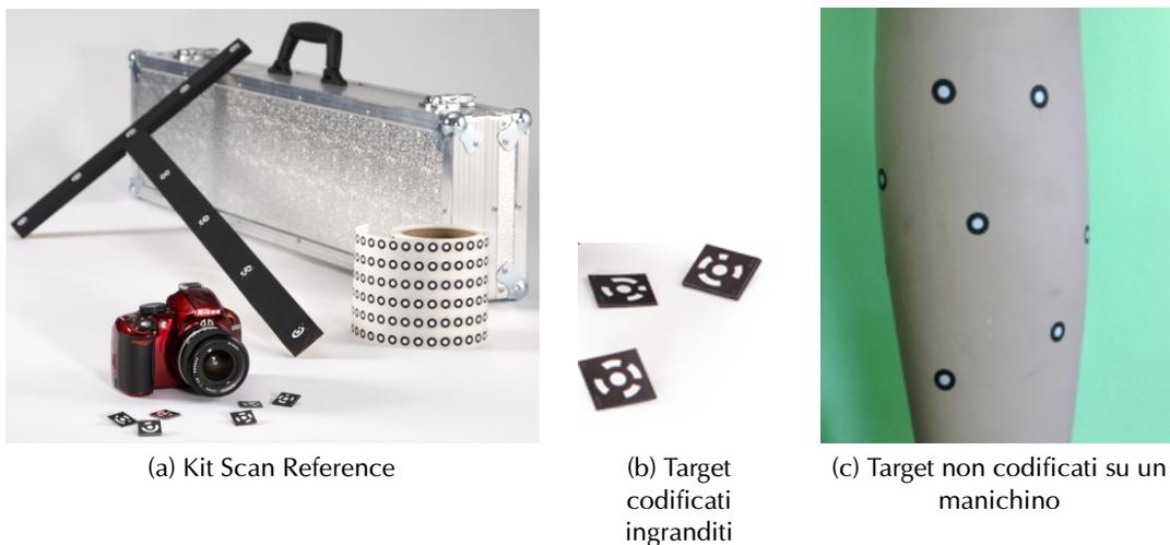
Figura 2.12: Kit e target Scan Reference (a). Da sinistra a destra: target codificati (sul piano), camera digitale, croce per la scala, rotolo di target non codificati, valigia
