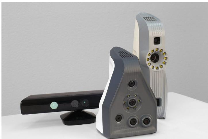
Figura 1.1: Scanner 3D, da sinistra a destra: Microsoft Kinect (terze parti), **Spider**, **EVA**
